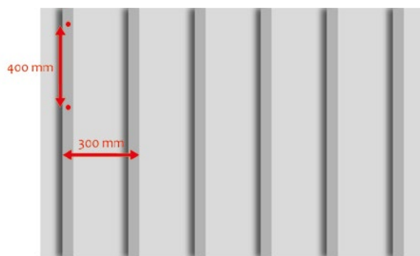
Układanie legarów przy poziomym układzie profili elewacyjnych
