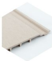
CP140 (profil fasadowy) Szerokość całkowita: 173 mm Grubość: 13 mm Szerokość kryjąca: 150 mm
